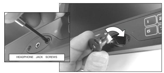
1) UNSCREW THE JACK ASSEMBLY SCREWS, ALTERNATING LEFT AND RIGHT IN ORDER TO BACK THE ASSEMBLY OUT.
